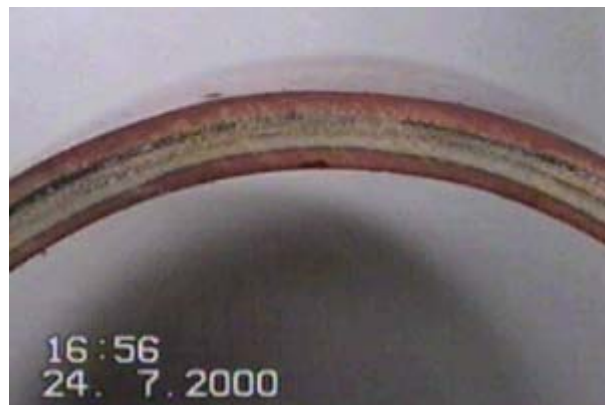
Рис.3. Структура стенки газоотводящего ствола (увеличено)
